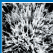
Cristallisation Xypex (achevée)
